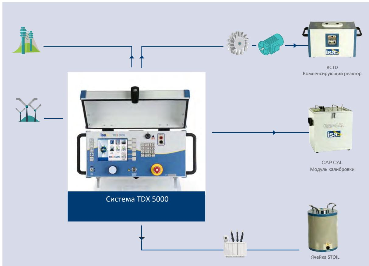
Испытание силовых трансформаторов
