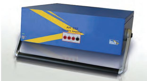
Усилитель тока AMI 332 является дополнительным модулем для DRTS 34. Для его работы требуется IRIG-B соединение и модуль расширения выхода. AMI 332 включает в себя три генератора тока по 32 А. Совместное использование DRTS 34 и AMI 332 позволяет получить:
