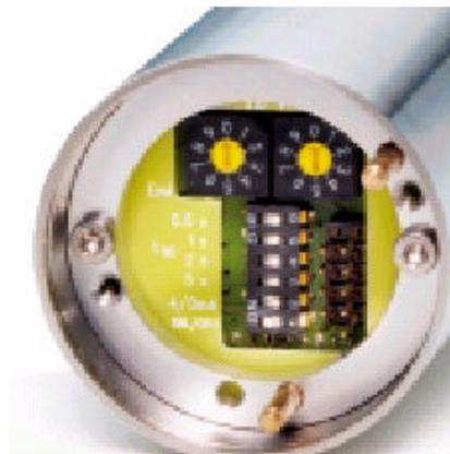
→ Коэффициент излучения, время отклика, аналоговый выход (0... 20 мА или 4... 20 мА) и режим работы (в системе/автономный) могут быть установлены непосредственно на самом пирометре.
