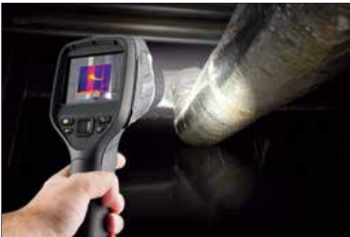
Встроенная светодиодная лампа освещает темные области, что позволяет получать цифровые изображения лучшего качества и обеспечивает безопасность.
