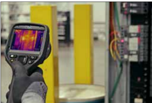
Лазерный указатель помечает цель и обозначает ориентиры на изображениях в видимом спектре.
